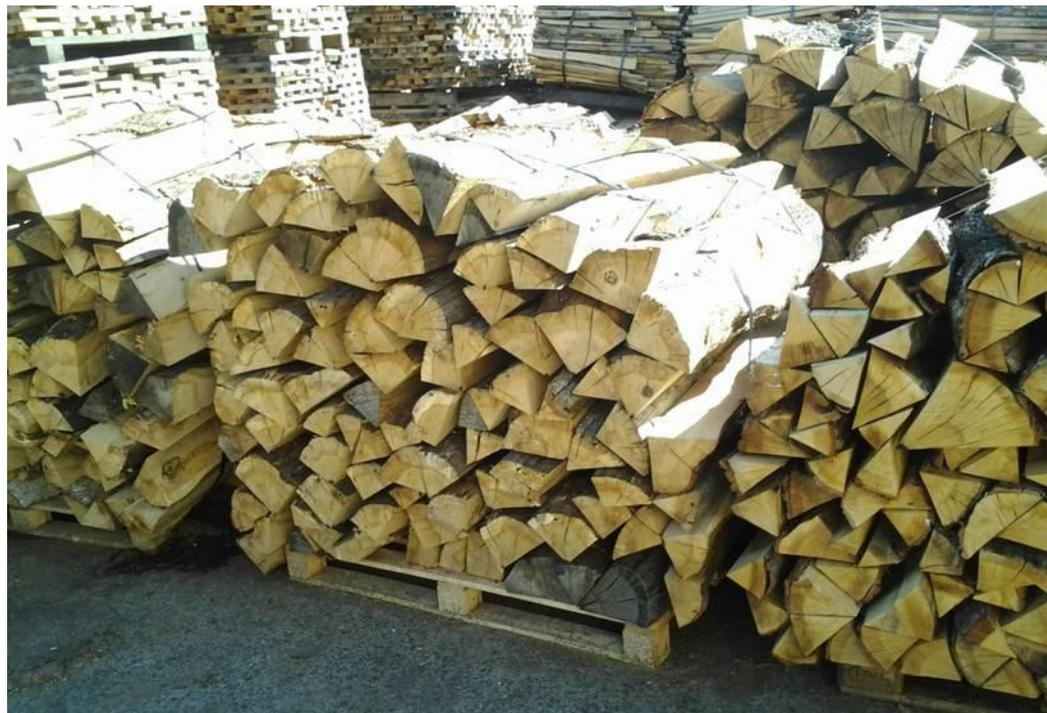
**Palets de leña derivados del proceso de aserrado de rolla de roble para obtención de duelas en fábrica de barricas Quercus en Laguardia, Alava. Ejemplo de BFS. Foto: autor**
