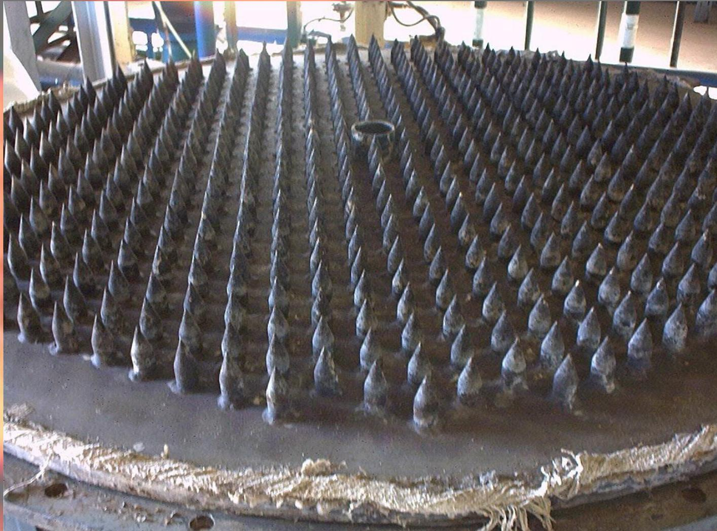
Vista de la placa de distribución de campanas de una planta de combustión de biomasa de lecho fluidizado
